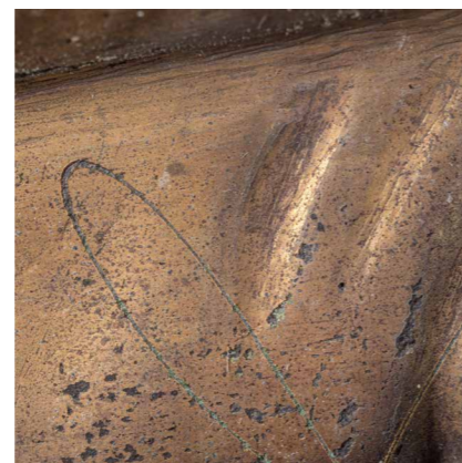
Obr. 8 Větší detail předchozího snímku. Laser v podobě tenké linky odstranil zlacený povrch a propálil se do korozních produktů mezi měděným podkladem a zlacenou vrstvou. Olomouc, Čestný sloup Nejsvětější Trojice, sousoší Nanebevzetí Panny Marie. [PG, 2025]
