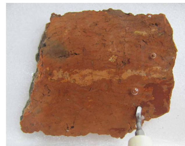
Obr. 4 Uvolňování laků a barev z povrchu pomocí zubního ultrazvukového čističe za současného ponoru ve vodě. [LK]
