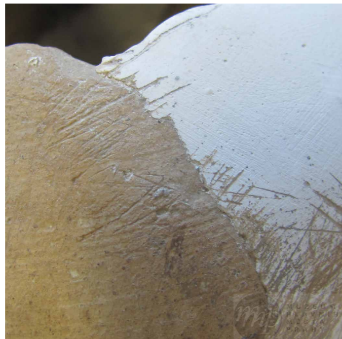
Obr. 8 Nešetrné opracování doplněku hrubými nástroji, které razantně poškodily povrch předmětu. [LK]
