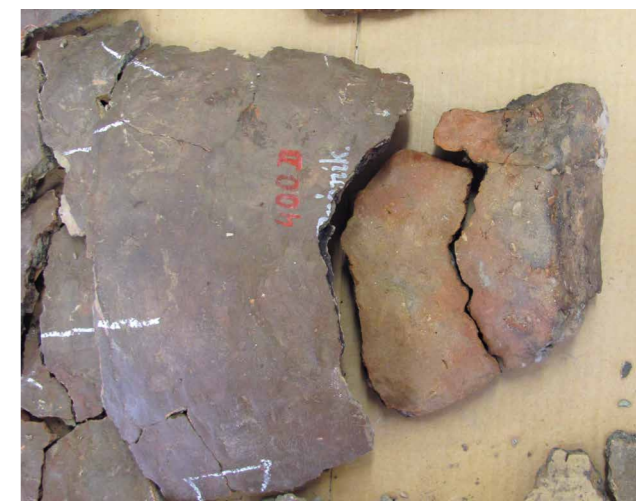
Obr. 3 Rozdíl v barevnosti originálního povrchu keramiky a historického nátěru. [LK]
