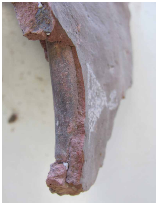
Obr. 7 Sádrová vrstva pokrývá celý povrch zlomku, použitého jako stabilizační doplněk. Tento stav urychluje degradaci střeptové hmoty. [LK]
