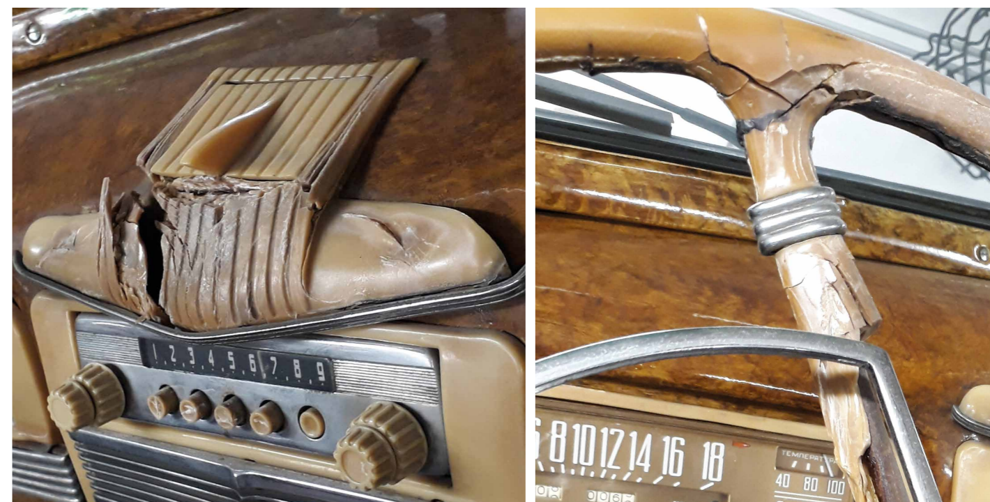
Obr. 3 Rozpadající se kaseinformaldehydové (galalitové) prvky vnitřního vybavení automobilu Zill (expozice NTM). [IK, 2021]
