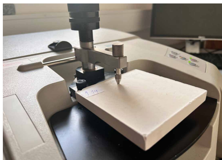
Obr. 3 Příprava a měření sádrového vzorku po umělém stárnutí pomocí ATR-FTIR analýzy (Nicolet iZ10, Thermo Scientific). FTIR spektroskopie byla využita k ověření možných chemických změn a přítomnosti degradačních produktů v důsledku kontaktu s polymerními materiály během stárnutí. Měření probíhalo s ATR příslušenstvím a diamantovým krystalem. [ŠV, 2025]
