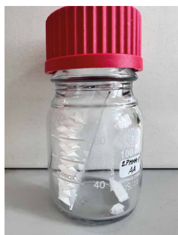
Obr. 5 Experimentální uspořádání cross-infection testu – polymerní vzorek PMMA-1 uzavřený společně s referenční celulózu (filtrační papír Whatman No. 1) ve skleněné vialce. Vzorky byly hermeticky uzavřeny a uměle stárnuty při 80 °C s cílem sledovat emise těkavých organických látek (VOC) a jejich nepřímý degradační účinek na citlivý organický materiál v uzavřeném mikroprostředí. [ŠV, 2025]
