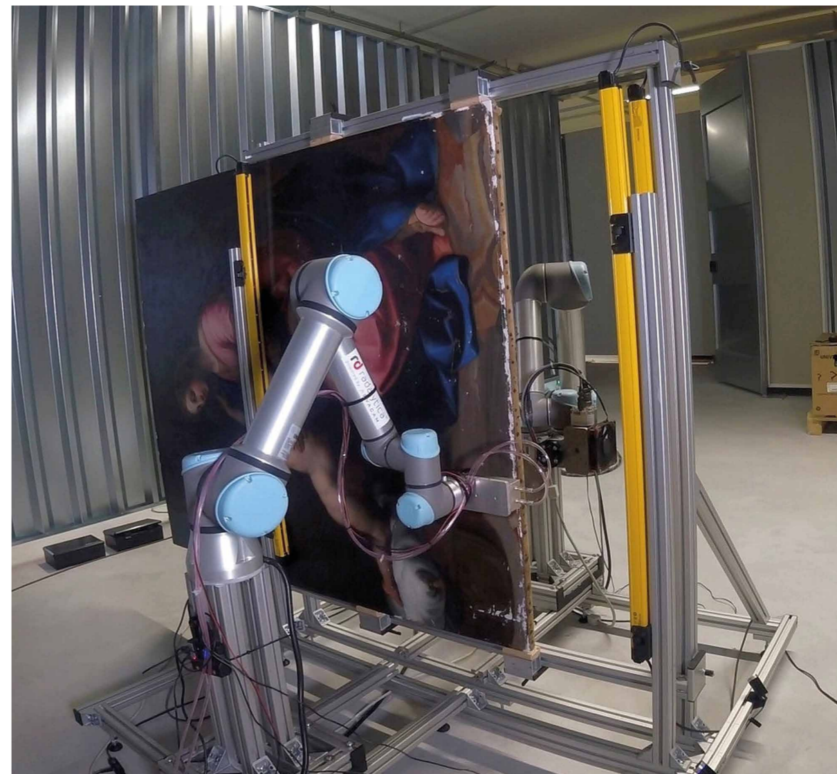
Obr. 1 Systém robotického multimodálního zobrazování je plně mobilní a lze ho dopravit na místo analýzy rozměrných objektů.
