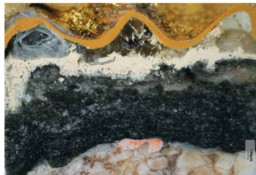
Obr. 5, 6 Nábrus degradovaného povrchu s nátěry a zlacením, mikrofoto v bílém odraženém světle rastrovacím elektronovým mikroskopem. Snímek prokázal sádrovcovou výplň v hornině a složení stratigrafie včetně původního (?) suříkového rezidua i styrenakrylátového sjednocujícího spodního nátěru. [KB]
