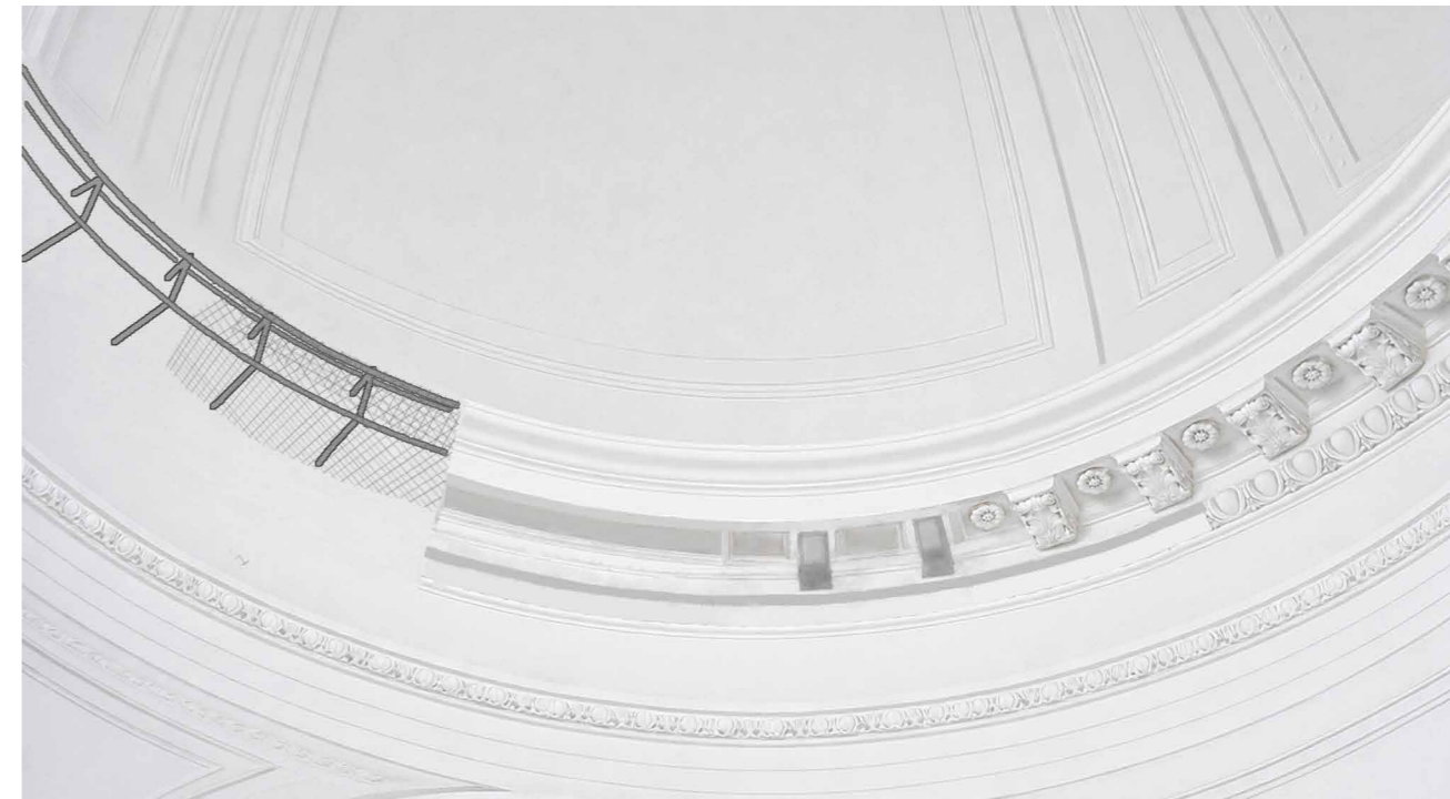
Obr. 11 Vizualizace postupu tvorby korunní římsy v tamburu mauzolea. [ZK]
